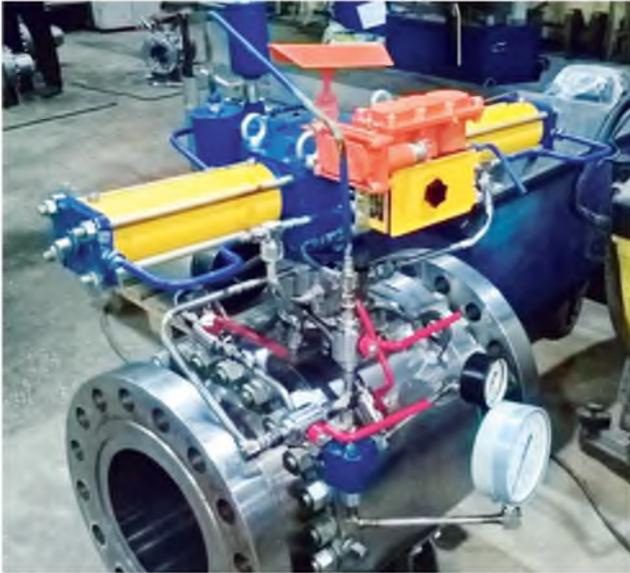
**Рис. 12. Макет схемы управления шаровыми кранами с управляемыми седлами, подготовленный к проведению испытаний (АО «МосЦКБА»)**
