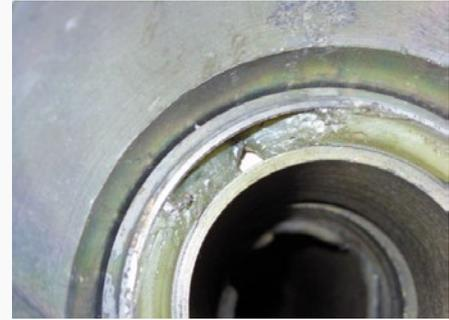
**Рис. 5.** Уплотнение, разрушенное в результате явления «взрывной декомпрессии»
