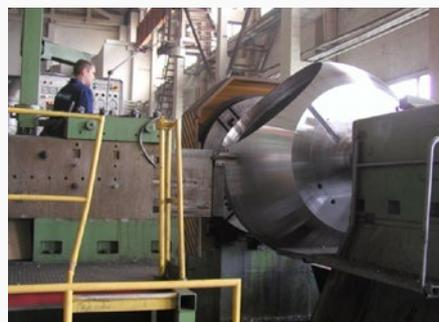
**Рис. 2.** Обработка шаровой пробки крана большого типоразмера [1]
