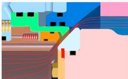
**Рис. 15.** Отвод из потока рабочей среды подвижного уплотнительного элемента из полимера и защита его от эрозионного износа в начале поворота запорного органа крана
