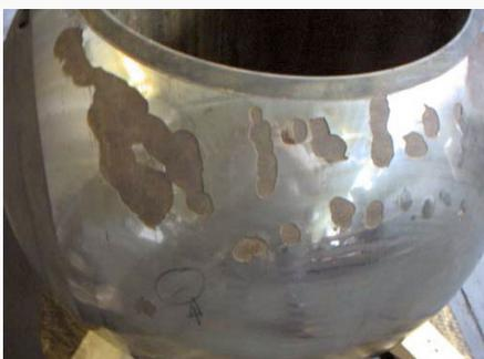
**Рис. 4.** Повреждение покрытия шаровой пробки [2]
