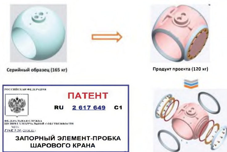
Рис. 6. Ремонтируемый запорный орган шарового крана
