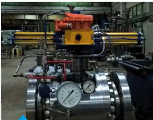
Рис. 11. Макет схемы управления шаровыми кранами с управляемыми седлами, подготовленный к проведению испытаний (фронтальный вид)
