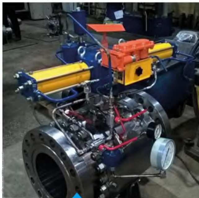
Рис. 12. Макет схемы управления шаровыми кранами с управляемыми седлами, подготовленный к проведению испытаний (вид слева)
