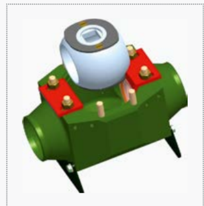
Рис. 9. Извлечение шаровой пробки из корпуса крана
