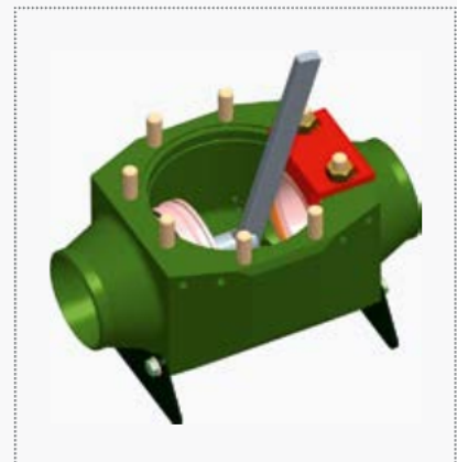
Рис. 10. Установка седел в корпус при сборке крана
