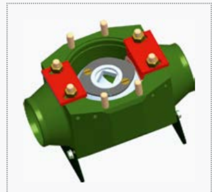
Рис. 8. Фиксация седел скобами в разведенном состоянии
