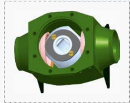
Рис. 7. Перемещение седел кулачками при повороте шаровой пробки на угол 135^\circ
