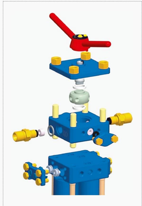
Рис. 9. Модульная конструкция насоса «Тандем»
