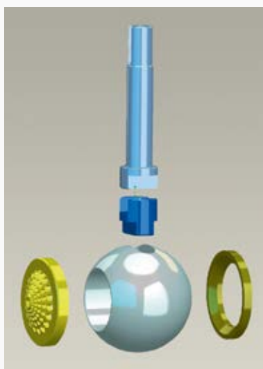
Рис. 9. Промежуточная муфта в соединении шпинделя с шаровой пробкой
