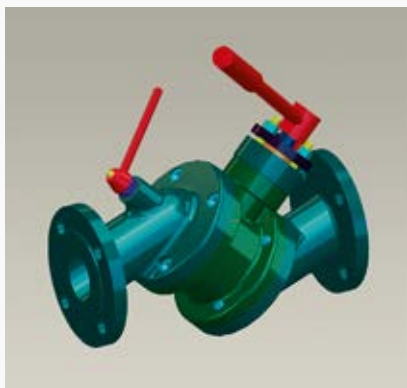
Рис. 6. Новый запорно-регулирующий шаровый кран гибридной конструкции
