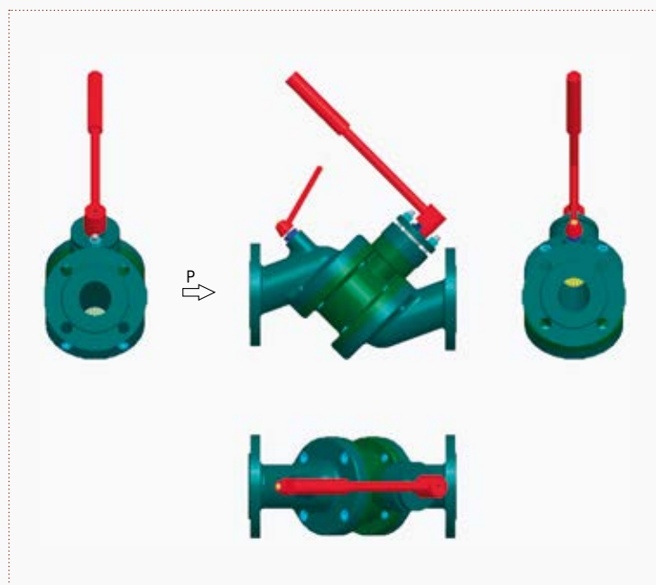
Рис. 11. Новый запорно-регулирующий шаровой кран гибридной конструкции
