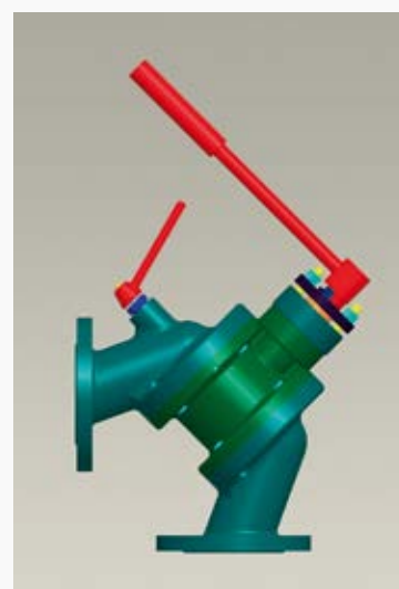
Рис. 10. Новый запорно-регулирующий шаровый кран гибридной конструкции в угловом варианте сборки
