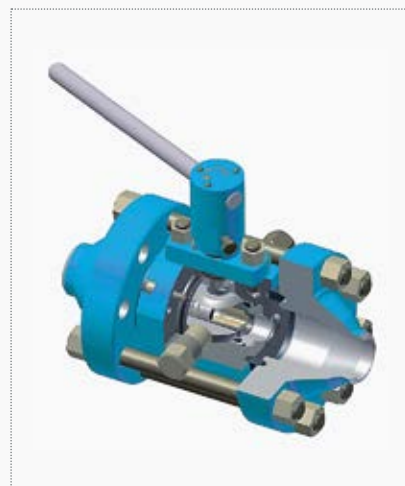
Рис. 8. Шаровой кран со сменной дроссельной втулкой [2]
